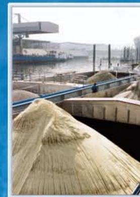
Oberrhein- und Niederrhein-Sand, sortiert in Körnungen 0-2, 0-4 für Estrich, Putz und Beton. Außerdem Lava, Kalk-Splitt und Füllmaterialien.
