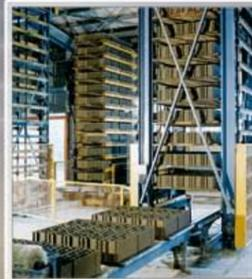
Kreislauf: Der Austausch von frisch geformten und bereits erhärteten Steinen erfolgt vollautomatisch.
