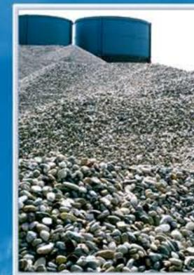
Oberheinkies, sortiert in Körnungen 2-8, 8-16, 16-32, 0-16, 0-32 für Spannbeton, Transportbeton und Betonware sowie Moräne-Edelsplitt, sortiert in Körnungen 0-5, 2-5, 5-8 für Straßendecken.
