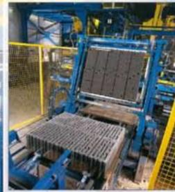
Kein umständliches Drehen am Bau. Steinlage für Steinlage wird vor dem Ausliefern gewendet.
