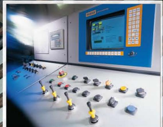
Computergestützte Fertigung sichert eine gleichbleibende Qualität. Vollautomatisch werden beispielsweise Rezepturen gemischt, Steine umgesetzt, Kapazitäten berechnet und Fertigungsmengen an den Zentralcomputer gemeldet.
