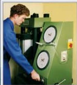
Gewicht, Rohdichte und Druckfestigkeit werden im eigenen Labor strengen Prüfungen unterzogen.
