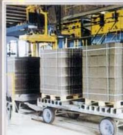
Stahlbänder umschließen das palettierte Steinpaket. Hohe Sicherheit beim Transport und beim Entladen.
